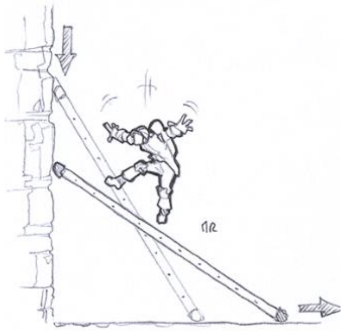
Échelle trop inclinée © Matthieu Robert
