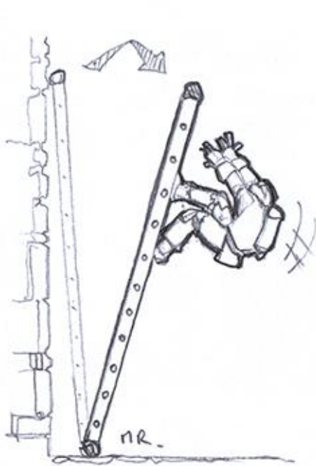
Échelle positionnée trop près du mur
