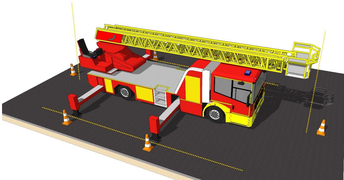
Matérialisation de la zone de travail au moyen de cônes de Lubeck © Guillaume Vermeulen – SDIS 59
